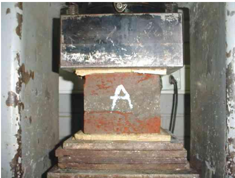
Probeta de ladrillo artesanal listo para ensayo
