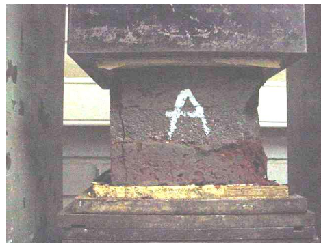
Probeta de ladrillo artesanal después del ensayo
