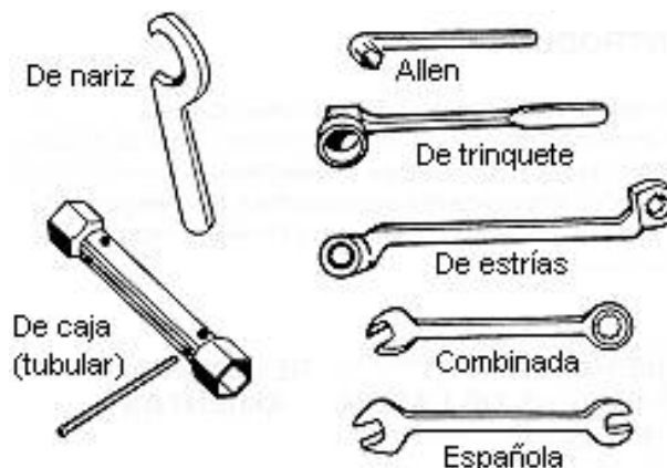
Fig. 18: Tipos de llaves de boca fija
