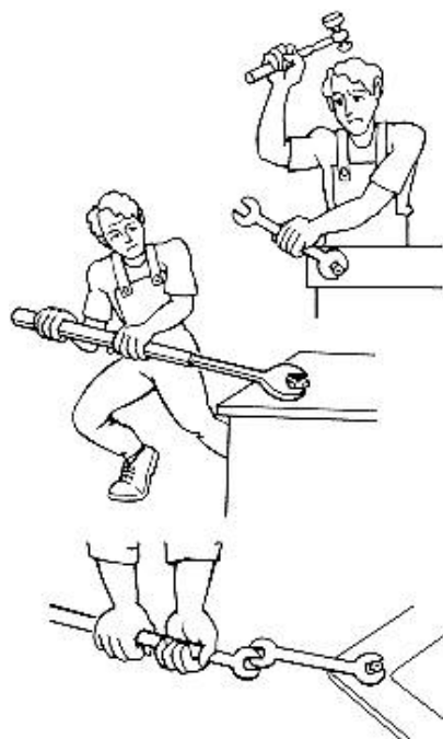
Fig. 22: Utilizaciones correctas e incorrectas de fijas
