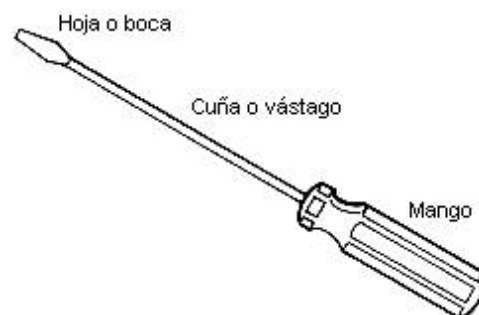
Fig. 10: Partes de un destornillador
