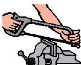
Fig. 36: Pieza fijada firmemente antes de cortar.
