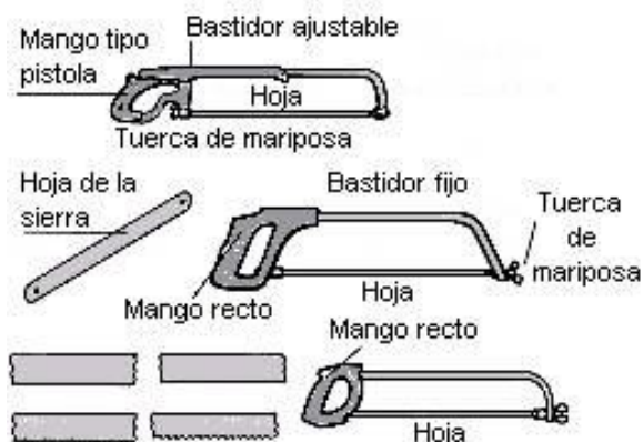
Fig. 35: Partes y tipos de sierras de arco.
