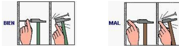
Fig. 33: Forma de sujetar un clavo antes de clavarlo.
