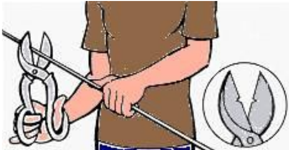
Fig. 38 Utilización incorrecta de tijeras con hojas melladas.
