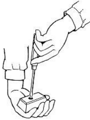
Fig. 13: Sujeción incorrecta de una pieza a atornillar
